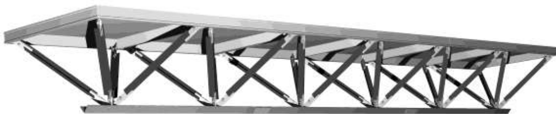
Рис. 3.54. Общий вид сталежелезобетонной пространственной фермы
